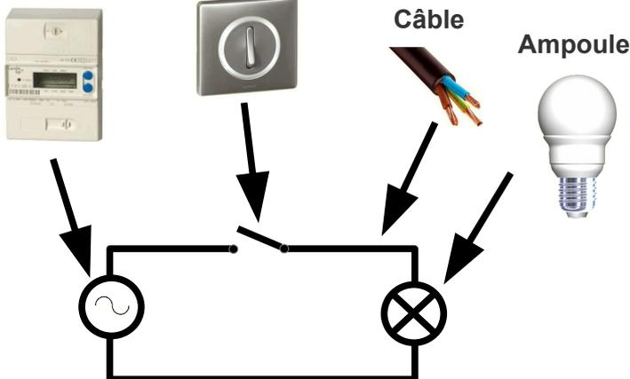
Schéma du fonctionnement d'un circuit électrique d'éclairage
